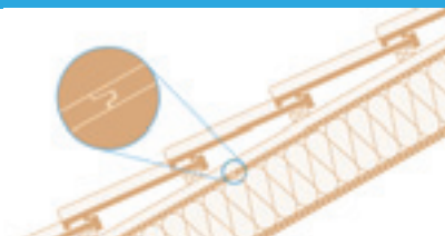
Vollsparrendämmung mit Unterdeckung
